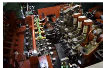
圧造加工機内部 (5ダイ5ブローパーツフォーマー)
